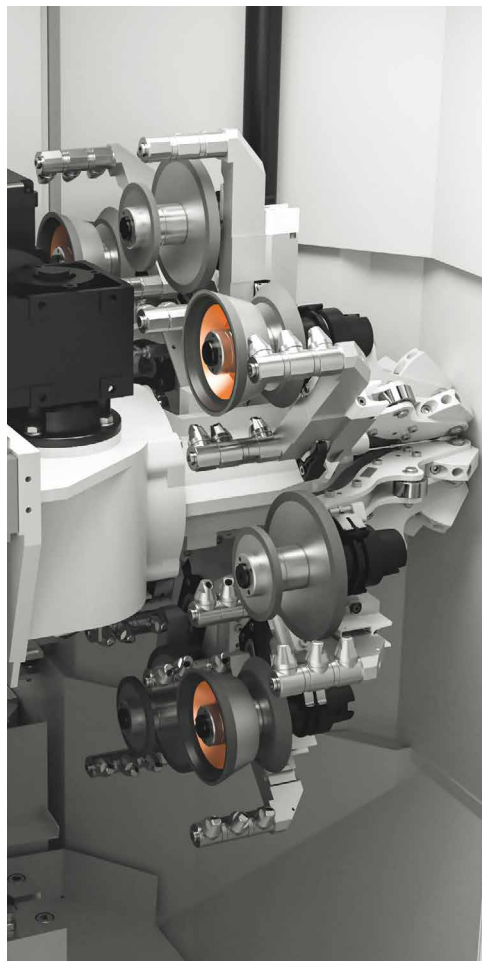
//////// CAMBIADOR DE MUELAS ABRASIVAS DE 8 POSICIONES con inyectores de líquido refrigerante
