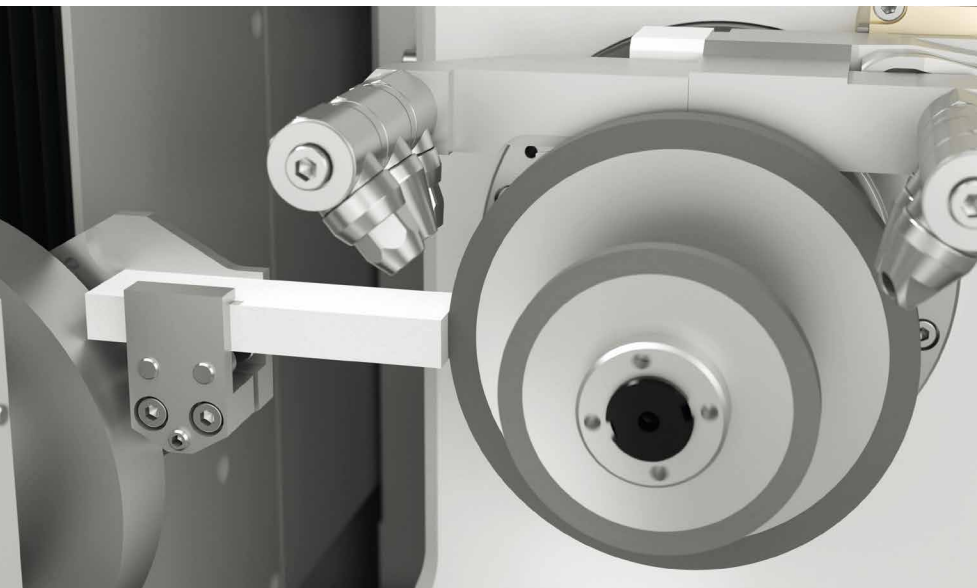
////// UNIDAD DE LIJADO para la apertura del revestimiento abrasivo
