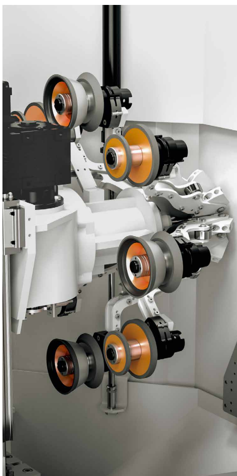
//////// DISPOSITIVO 8X PER CAMBIO MOLE DI AFFILATURA per un efficiente cambio mole con riduzione dei tempi di inattività
