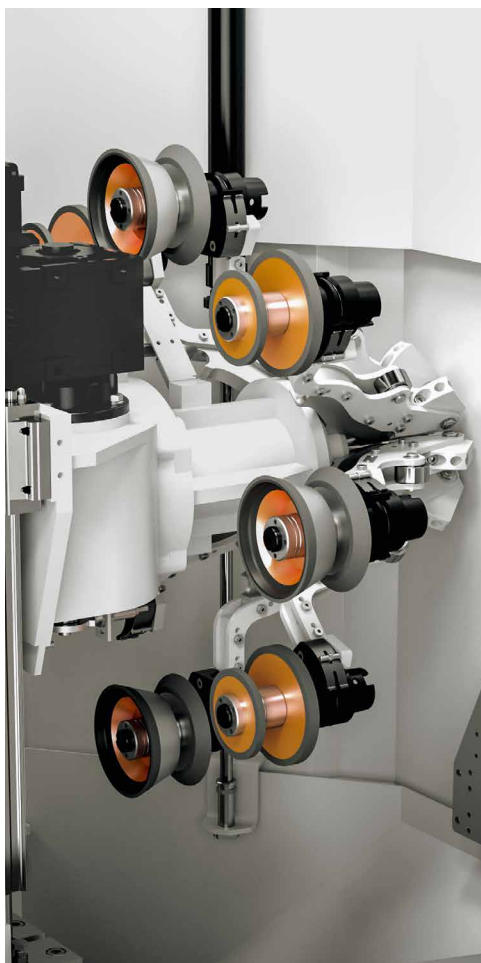
//////// 8-KROTNY ZMIENIACZ ŚCIERNIC do efektywnej zmiany ściernic i redukcji czasów przejściowych
