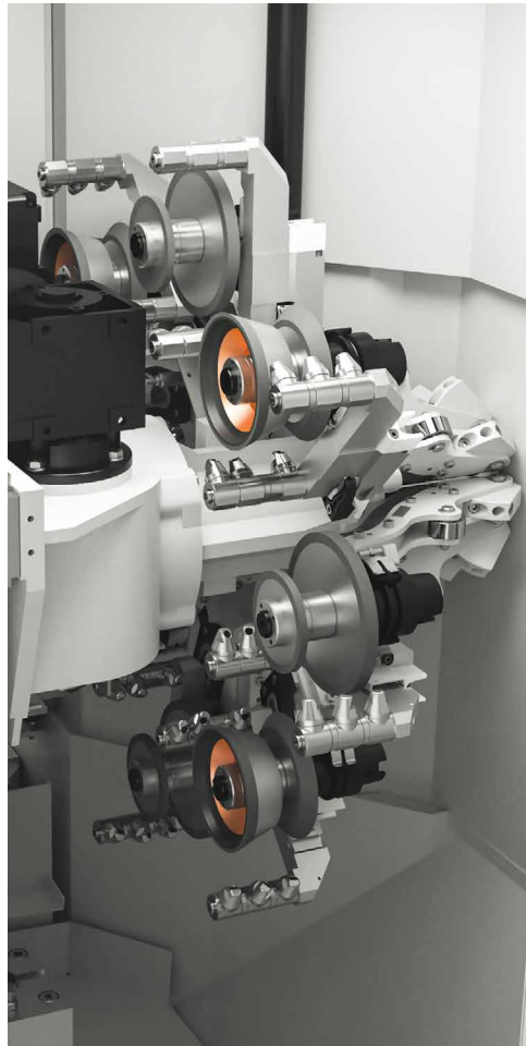
//////// 8工位砂轮库 包含冷却液喷嘴
