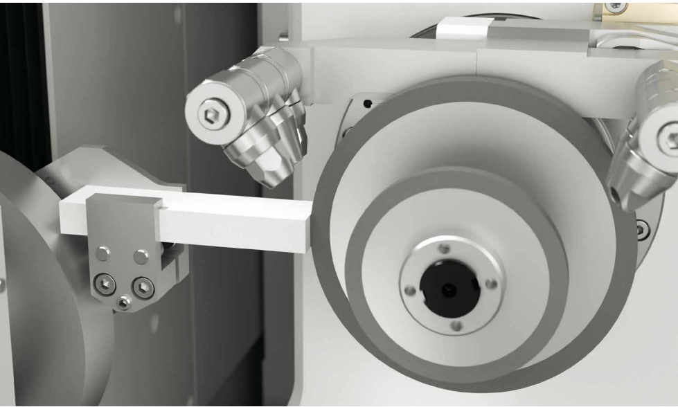
//////// 砂轮修整装置 用于解决砂轮堵塞问题
