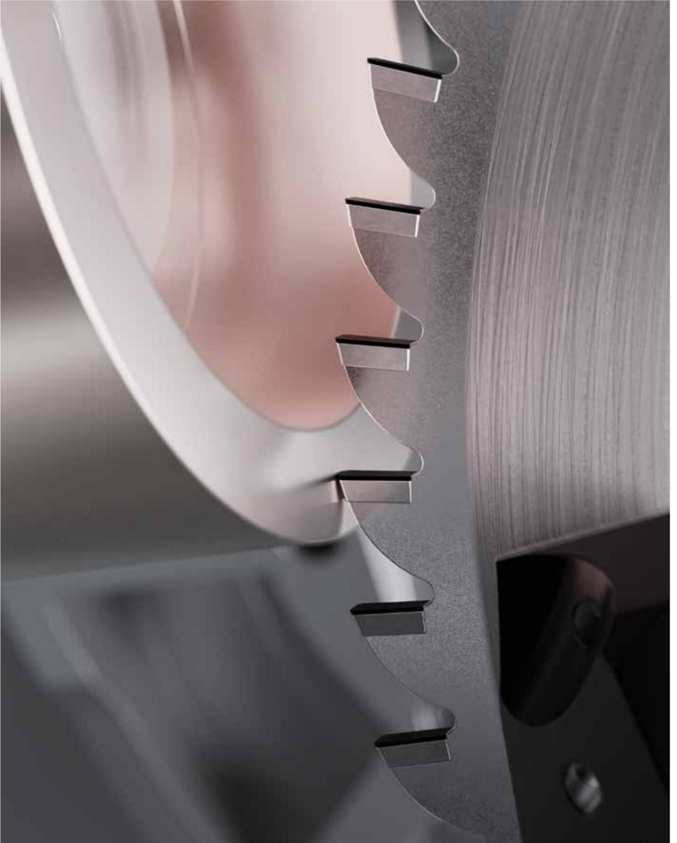
///// USINAGE CIRCONFÉRENTIEL DE LA FACE DE DÉPOUILLE
