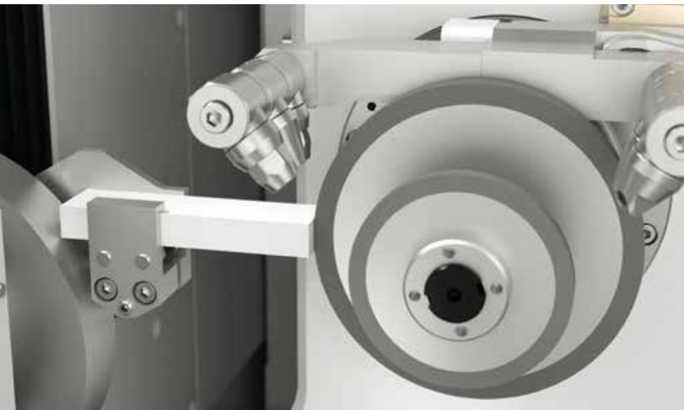
////// UNIDADE DE DESBASTE para abertura do revestimento do rebolo
