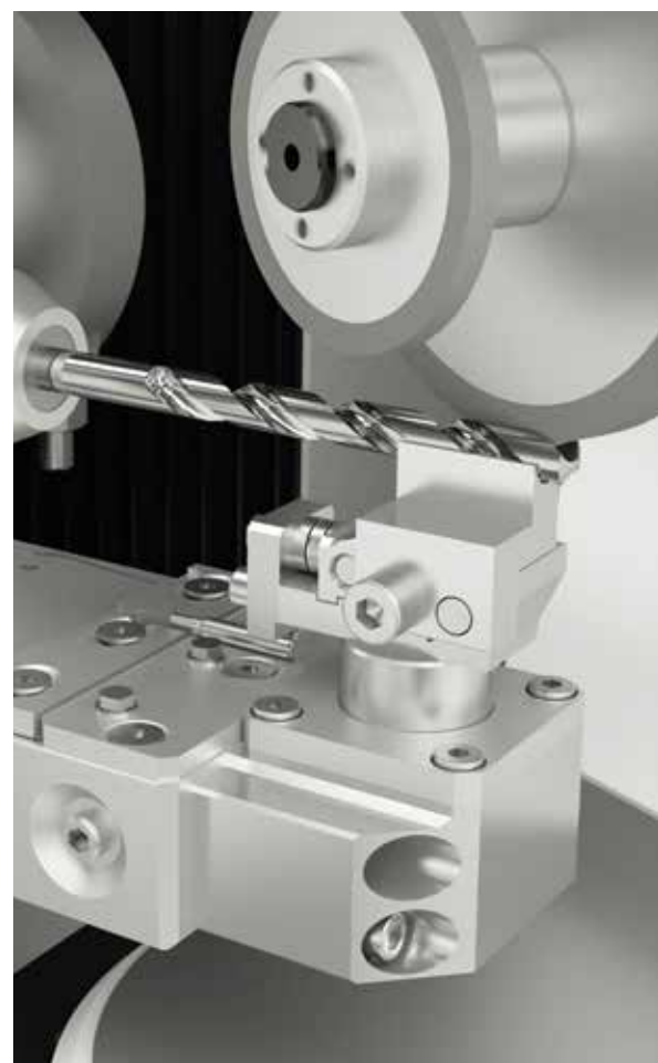
////// BISEL COM CURSO AUTOMÁTICO garante um resultado de afiação ideal em ferramentas mais longas
