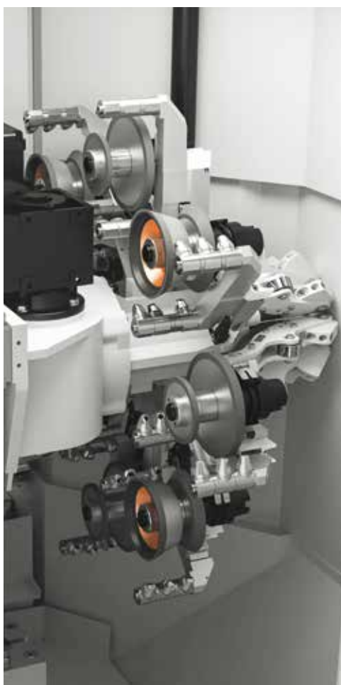
//////// TROCADOR DE REBOLOS ÓCTUPLO incluindo injetores de refrigeração
