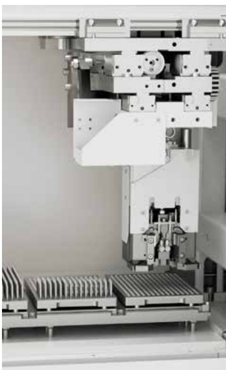
////// CARREGADOR DE PALETES HP 160 para a alimentação rápida de até 900 ferramentas
