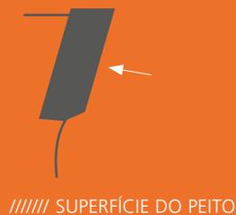
4. Posicionamento do rebolo na garganta do dente, afiação de dentro para fora e de fora para dentro sem recua do rebolo
