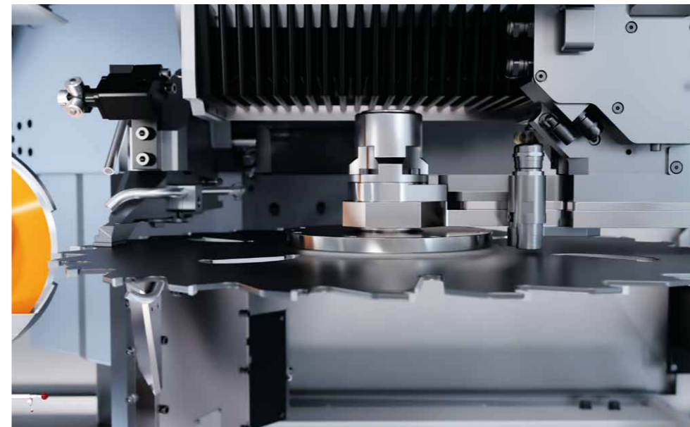
/////// 制御された横方向調整 カラー付き鋸を混在させた連続自動加工
