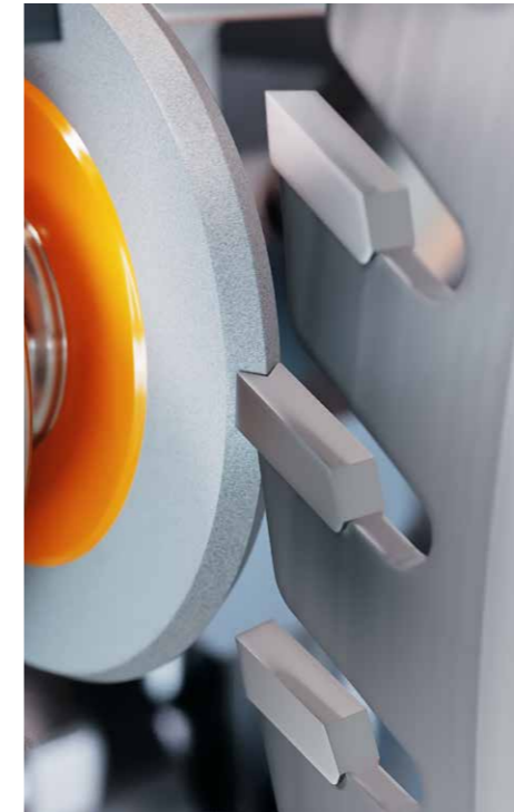
//////// 逃げ面での V 溝加工
