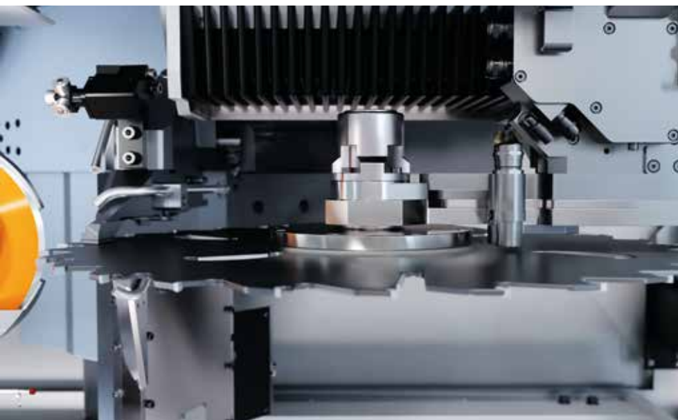
////// REGOLAZIONE TRASVERSALE CONTROLLATA Lavorazione automatica delle lame con dispositivo di morsaggio in modalità mista
